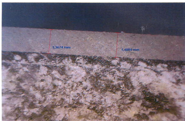
Měření tloušťky podlahoviny, stanovena 1,40 mm
